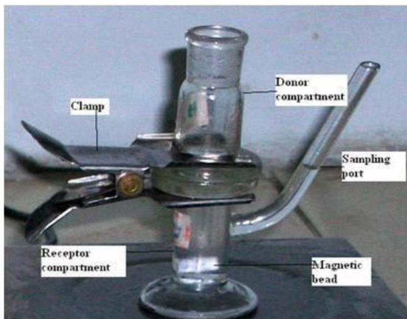
**Figure 4: diffusion study apparatus.**
