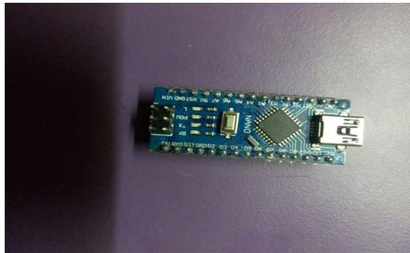
**Fig: Arduino Nano controller.**
