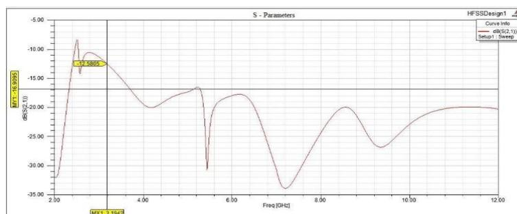
**Fig.3  $S_{21}$  parameter of MIMO antenna.**
